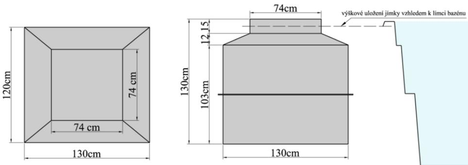
Není-li technologie uložena v šachtě, která je součástí tělesa bazénu, může být umístěna např. v technologické jímce jejíž zabudování je následující. Jímka je standardně dodávána v rozměru 130 x 120 x 130cm (viz obr.), velikost jímky však může být také individuální, při jiné velikosti je nutné přípravné práce přizpůsobit dané konkrétní velikosti.
